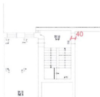
Ilustrācija Nr. 9 - 5.stāva izmērītie sienu biezumi ar apdari.
